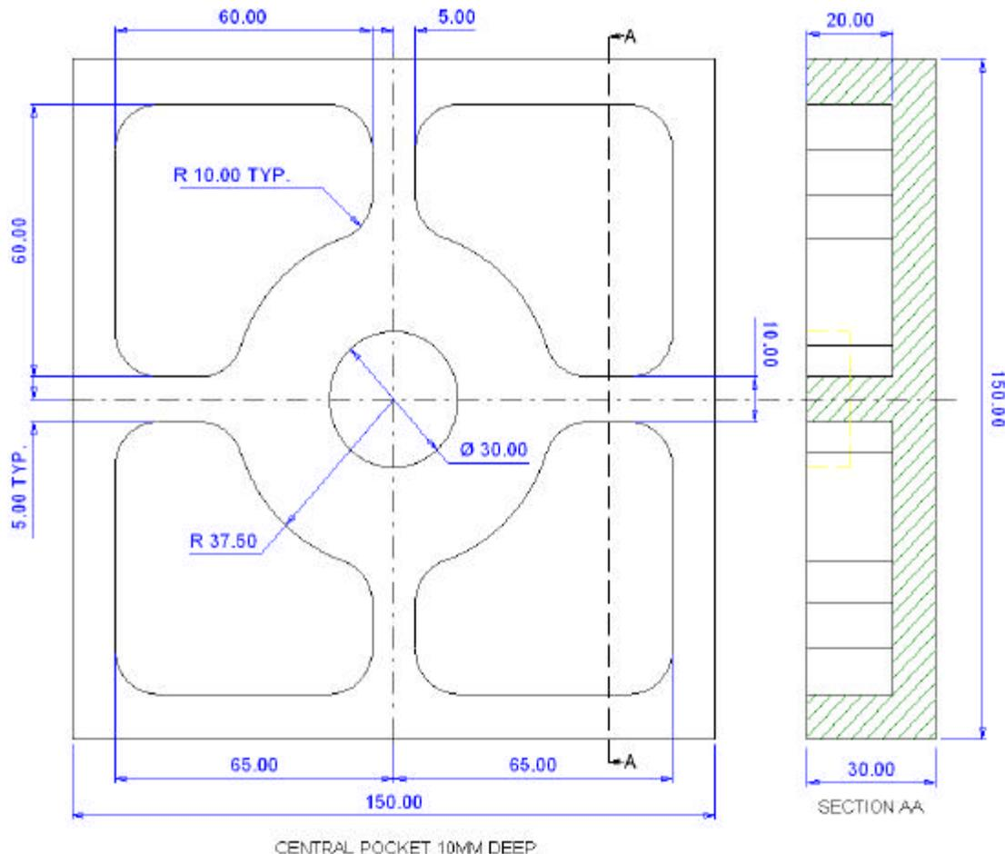
Debido a que las cavidades son simétricas, podemos usar los siguientes comandos, espejo o de rotación en 2D para créalo. Nosotros usaremos las dos maneras. Primero crearemos las líneas de fuera del elemento, después, las cavidades de arriba, y la derecha
