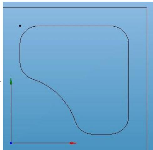
Antes de mirar los comandos de rotación y de espejo, necesitamos juntar todas las partes de la cavidad, para crear un objeto (curvo).
