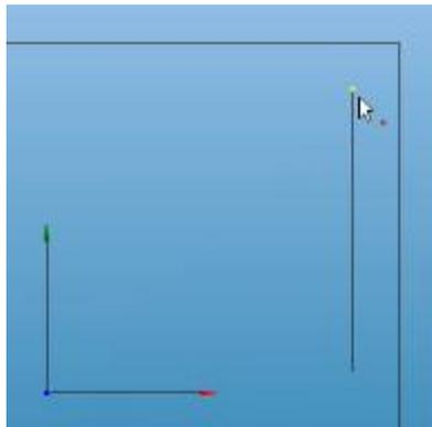
En el dialogo X introduce 5 y presiona Intro, en Y introduce 65 y presiona Intro. En el área gráfica, haz clic en la nueva línea recién creada, mediante el complemento de punto final, haz clic en el final de la línea vertical.
