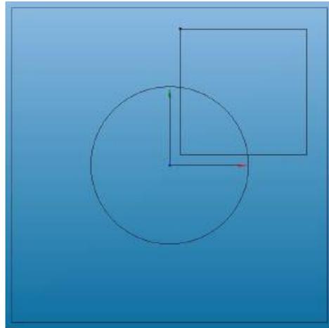
Ahora insertaremos radios de 10mm en los empalmes. Haz clic en el botón de redondeo y corte. En el valor R introduce 10, y mirando la siguiente imagen, haz clic en la línea 1
