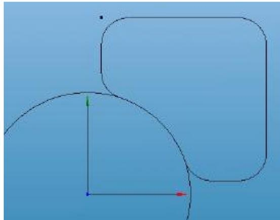
Ahora, necesitamos separar el círculo, del arco que necesitamos. Para hacer esto, selecciona el icono de recortar y seguidamente, selecciona la parte del círculo que desees recortar. Debería quedarte algo parecido a esto:
